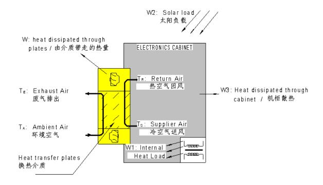
热交换器通常用在对密封区域的降温, TE\*\*\*/\*/D系列的热交换器是专为机柜而设计的产品。热交换器因需要环境温度进行调节,因此需要有一个通道与外界相通。密闭的内部空气通过环境空气而实现冷却。内、外循环的离心风扇使空气产生对流,通过中间的换热装置实现热量的传递。
