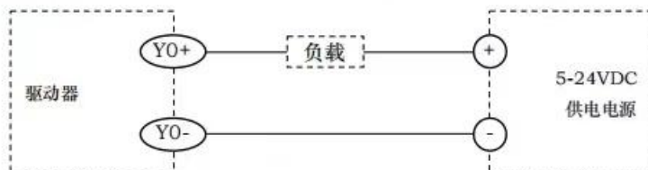
将输出Y0接成sinking型输出
