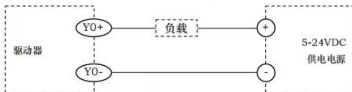
将输出Y0接成sinking型输出
