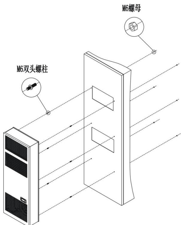
Fig. 3.1 CGE100-A2H11 安装开孔图
