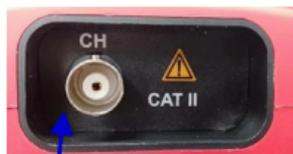
Oscilloscopio ingresso sonda terminale, massimo apporto tensione: 400V (picco CC+CA valore)
