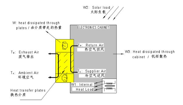
热交换器通常用在对密封区域的降温,是专为机柜而设计的产品。热交换器因需要环境温度进行调节,因此需要有一个通道与外界相通。密闭的内部空气通过环境空气而实现冷却。内、外循环的离心风扇使空气产生对流,通过中间的换热装置实现热量的传递。
