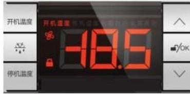
显示板可以显示三个数字，一个状态指示符（按键锁），两个参数描述字（开机温度、停机温度）。
