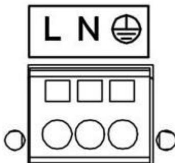
交流电源输入接线端定义：
