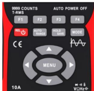
**F1-F4 key:** die dem auf dem Bildschirm angezeigten Funktionsmenü entsprechen, wählen Sie die entsprechende Funktion mit der Taste aus, wie in der Abbildung oben dargestellt.
