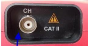
Oszilloskop-Tastkopf-Eingangsklemme, maximale Eingangsspannung: 400 V (DC+AC-Spitzenwert)
