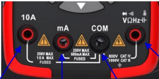
Positiver Stromübertragungsanschluss, der maximale Eingangsstrom beträgt 10 A
